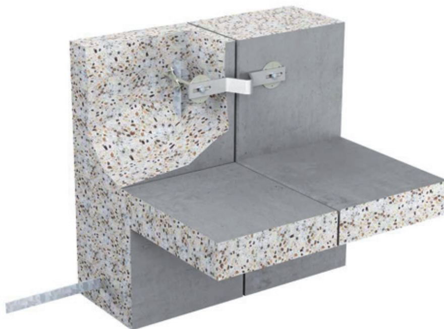
Rysunek 5: Mostkowanie połączeń ruchomych poprzez złącze dylatacyjne
