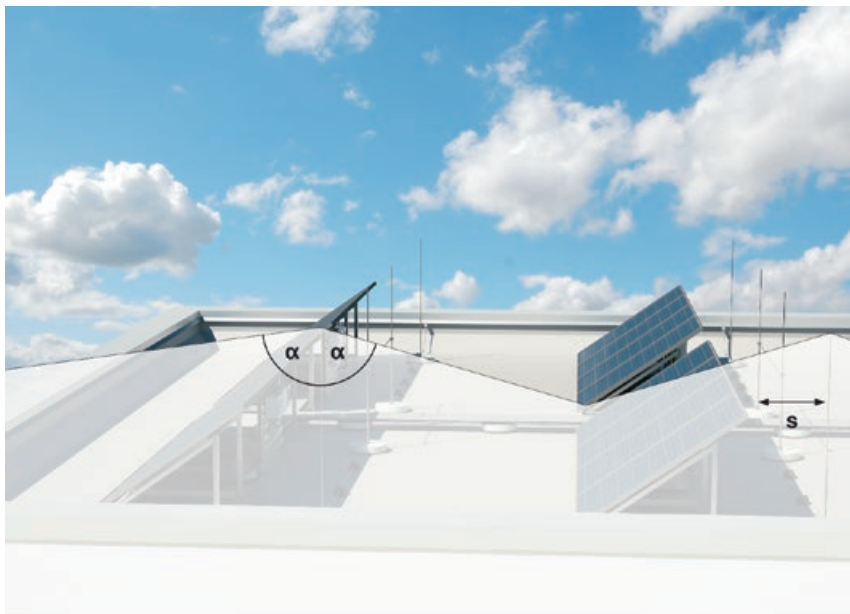
\alpha^\circ = Kąt ochronny, s = Odstęp separacyjny
