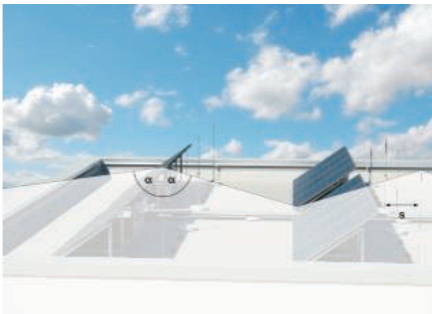
\alpha^\circ = Kąt ochronny, s = Odstęp separacyjny
